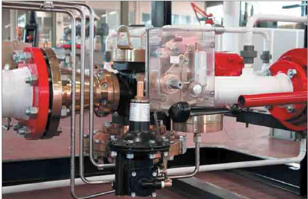
*Блок редуцирования с регулятором в исполнении CB-SRS. Поток газа справа налево.*
